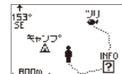
地図ページ 登録されたポイント、現在地、軌跡などが表示されます。距離、方向などの位置関係がわかる地図画面です。※地図の転送・表示機能不可
