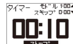
タイマーページ ラップタイム計測も可能なストップウォッチ機能。設定した時間の10秒前になるとカウントダウン音が鳴ります。
