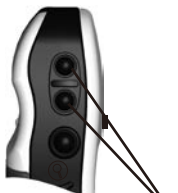
コントラスト調整のためズーム・ イン/アウトボタンを押す
